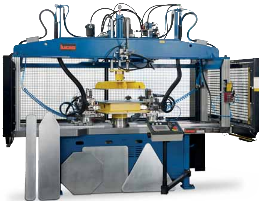
Vbu 2200 traffic signs. A very fast system for beading road signs, combined with M3-1600-Auto allows a high productivity with a single operator. Ideal for garden tables. Vbu 2200 segnaletica. Un sistema rapido per la bordatura di segnali stradali. In coppia con M3-1600-Auto consente un'altissima produttività con un solo operatore. Ideale anche per tavoli da giardino.
